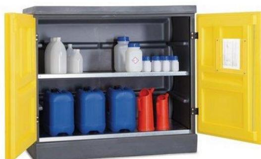
Los armarios de seguridad deben presentar una resistencia al fuego mínima RF-15, estar dotados de ventilación, con filtro de aire de circulación, y cuya extracción esté comunicada al exterior, que presente compartimentos interiores libres de metales, y con cajones estancos, que
